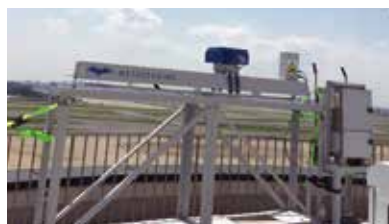
◀羽田空港に設置した地上設置型合成開口レーダ GB-SAR 装置
