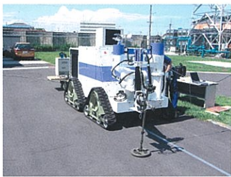
図1 地中レーダテスト中のSAR-GPRアンテナ
