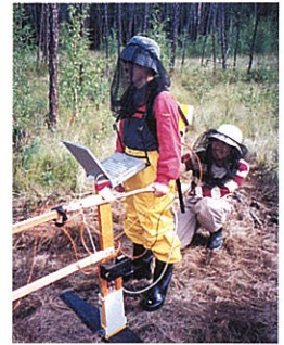
シベリア、タイガの中での地中レーダ計測
